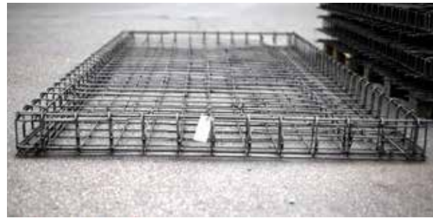
Balkonelement mit Aufbordung, Gefälle und Ablaufrinne.
